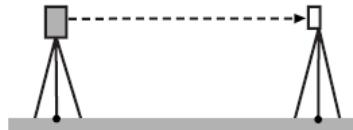
3. 在测量模式下，用盘左位置精确照准目标中心，读取水平角读数 A1 和垂直角读数 B1。
