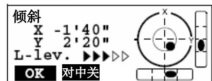
4.使用脚螺旋调整三脚架上的仪器位置至使对中激光点对准测点标志中心。
